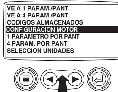
3. Una vez que se ha resaltado el ítem de menú "Configuración de Motor" toque la tecla "Ingreso" para ver los datos de configuración del motor.
