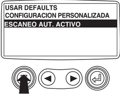
19. Toque la tecla “Menú” para volver al despliegue de parámetros del motor.
