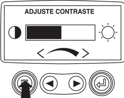
6. Toque la tecla “Menú” para salir del Menú Principal y volver al despliegue de parámetros del motor.
