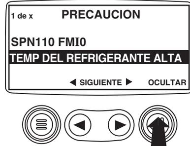
7. La pantalla de uno o cuatro parámetros desplegará el icono de falla hasta que la condición de falla sea corregida. NOTA: Si se ignoran los códigos de falla activos se pueden ocasionar daños severos al motor.
