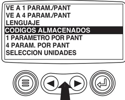
3. Ya resaltado el ítem de menú "Códigos de Falla Almacenados" toque la tecla "Ingreso" para ver los "Códigos de Falla Almacenados" (cuando sea aplicable, consulte con el fabricante del motor o transmisión para obtener los parámetros SAE J1939 soportados).
