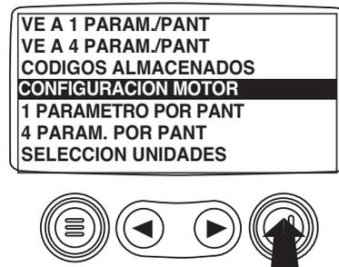
4. Use las "Flechas" para recorrer los datos de configuración del motor.
