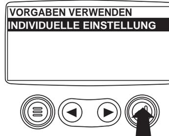
7. Das Rechteck mit dem von hinten beleuchteten Parameterwert ist der gegenwärtig ausgewählte Parameter. Verwenden Sie die "Pfeil-Tasten", um den Parameterwert in dem Rechteck, in dem Sie einen neuen Parameter geben möchten, zu markieren.
