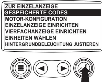
4. Falls das Wort "MEHR" über den "Pfeil-Tasten" erscheint, sind weitere gespeicherte Fehler-Codes zum Ansehen vorhanden. Verwenden Sie die "Pfeil-Tasten", um zum nächsten gespeicherten Diagnostik-Code zu rollen.
