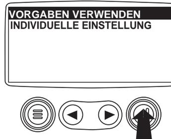
5. In der Rückstellperiode wird der "Vorgaben verwenden"-Schirm angezeigt und kehrt dann automatisch zu der "Vierfachanzeige einrichten"-Anzeige zurück.
