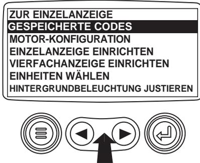
3 Nach Markierung der "Gespeicherten Fehler-Codes", berühren Sie die "Eingabe-Taste", um sich die "Gespeicherten Fehler-Codes" anzusehen (falls zutreffend, lassen Sie sich bitte in Bezug auf SAE J1939-gestützte Parameter von Ihrem Motor- bzw. Getriebehersteller beraten).
