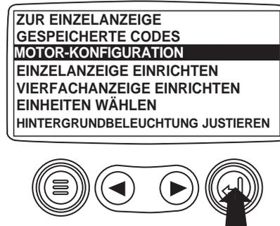
4. Verwenden Sie die "Pfeil-Tasten", um durch die Motorkonfigurationsdaten zu rollen.
