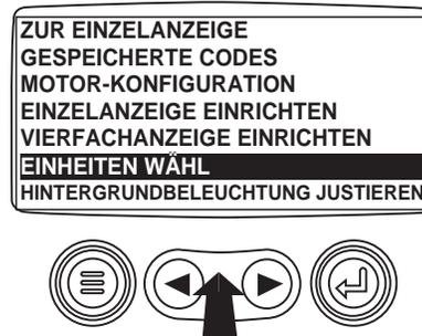
3. Nach Markierung von "Einheiten wählen" auf dem Menü, berühren Sie die "Eingabe-Taste", um die Funktion "Einheiten wählen" zu aktivieren.
