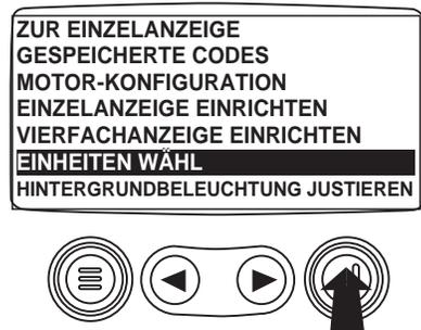
4. Verwenden Sie die "Pfeil-Tasten", um die gewünschte Einheiten zu wählen. "English" für Imperial-Standard, d.h. PSL, EF, oder metrisch kPa, metrische Bar für IS-Einheiten, d.h. kPa, Bar, EC.
