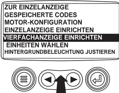
3. Nach Markierung von "Vierfachanzeige einrichten" auf dem Menü, berühren Sie die "Eingabe-Taste", um die Funktion "Vierfachanzeige einrichten" zu aktivieren.
