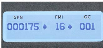
Las **pantallas de paro o aviso** activas se muestran cuando ocurre una falla. La pantalla muestra los valores de SPN, FMI y del contador de ocurrencias. Si hay más de una falla, el PV25 se desplazará automáticamente por todas las fallas.
